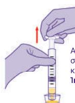
Αναρροφήστε με τη σύριγγα 1mL αέρα και στη συνέχεια 1mL δείγματος.
