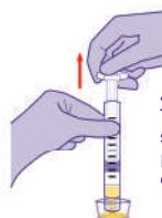
Aspirer d'abord 1mL d'air avec la seringue, puis 1mL d'échantillon.
