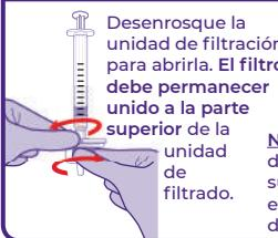
Desenrosque la unidad de filtración para abrirla. El filtro debe permanecer unido a la parte superior de la unidad de filtrado.
