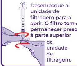
Desenrosque a unidade de filtragem para a abrir. O filtro tem e permanecer preso à parte superior da unidade de filtragem.
