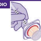
**Nota:** applicare una certa pressione sulla parte superiore per svitare l'unità di filtrazione.
