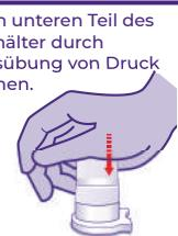
Den unteren Teil des Behälter durch Ausübung von Druck öffnen.
